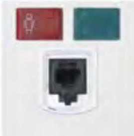
Über das Wandmodul LAN stehen am Bett die benötigten Rufanlagen- und Steuerfunktionen zur Verfügung. Anschluss über das selbstlösende Stecksystem eines System Com Patientenhandgeräts oder alternativ eines multifunktionalen Endgeräts. Wird die vordefinierte Zugkraft am Anschlusskabel des Handgerätes überschritten, löst sich der Systemstecker des Patientengeräts automatisch von dem Wandmodul ab, um einer mechanischen Zerstörung vorzubeugen.
