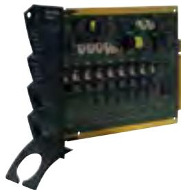
Einschubkarte für die Zentraleinheit zur Steuerung von bis zu 8 drahtgebundenen Basisstationen. Die Steuereinheit wird in die Zentraleinheit Clino Call DECTplus integriert und bearbeitet die Kommunikation und die Steuerung der Sprach- und Datensignale zwischen den angeschlossenen Basisstationen und den schnurlosen DECT-Telefonen nach dem DECT/GAP-Standard.
