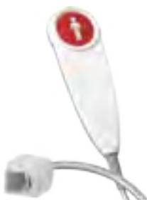
Birntaster in ergonomischer Gehäuseausführung (IP 67) mit antimikrobieller Oberfläche, Anschlussstecker selbstlösend A-kodiert mit einer Anschlussleitung von 2,5 m. Leicht bedienbare Ruffaste mit integriertem Findelicht. Ruffaste Ausführung in Ruhestrom.
