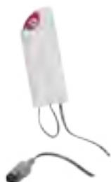
Birntaster mit Anschlussstecker 7-polig, Anschlussleitung und Leitungs-Einlegenut für variable Schlaufenbildung und Zugentlastung.
