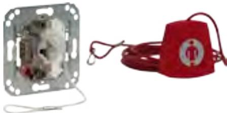
Ruftaster zum Anschluss an das Elektronikmodul oder Zimmerterminal über einen passiven Eingang. Anzeige der übergeordneten Zimmerkennung bei Rufauslösung. Funktionsüberwachung erfolgt durch das Elektronikmodul oder Zimmerterminal (Rufkreisüberwachung).
