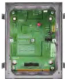
Vandalengeschützter Einbaukasten für das Zellenterminal ZT99 protect. Ausführung inklusive Dichtgummi, um die Schutzart IP 54 zu gewährleisten. Putzbündiger Einbau mit Spezialschrauben zur Sicherung gegen Sabotage. Ausgestattet mit Kabeleinführungen für die Zuleitung der notwendigen Verkabelung.
