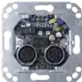
Rufeinheit zur Rufauslösung zum Anschluss an ein Elektronikmodul oder Zimmerterminal über einen passiven Eingang. Bewegliche Rufeinheiten wie Birn- und Mehrfachtaster werden an den Steckkontakten (7-polig) angeschlossen. Zusätzlicher Steckkontakt (6-polig) zum Anschluss einer medizinischen Einheit (z. B. Infusiomat) mit Alarmkontakt.
