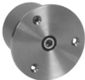
Sensortaster als Abstelltaster mit LED-Findellicht und Beruhigungslampe grün und 4-mm-Messingfrontplatte, glanzverchromt, ø 70 mm und 3 Innensechskantschrauben als Frontplattenbefestigung.
