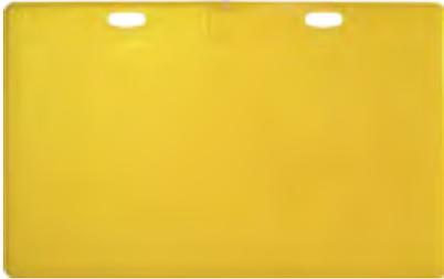
Druckempfindliche Sensormatte in schwerer, selbst liegender Ausführung. Besonders geeignet für den Einsatz vor dem Pflegebett oder im Türbereich. Stopperschutz durch kabellosen Funkanschluss (868 MHz) und abgeschrägten Kanten. Die Versorgung des Funkempfängers erfolgt über den 7-poligen Nebensteckkontakt der Rufanlage. Die Spannungsversorgung der Tretmatte erfolgt über eine 3-V-Batterie.
