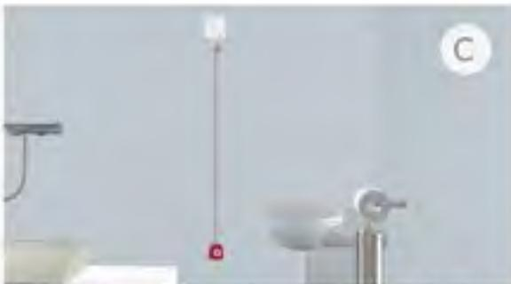
Zugtaster als Rufeinheit zur sicheren Auslösung im Bereich von Nasszellen. Die spritzwassergeschützte Einbaueinheit wird oberhalb des Wasseraustritts / Brausekopfes montiert und kann durch optionalen Dichtsatz zusätzlich Spritzwasser (IP67) geschützt montiert werden. Die rote 2 m lange PVC-Zugschur mit Knäuf und Rufsymbol ermöglicht eine sichere Rufauslösung, auch von am Boden liegenden Personen.
