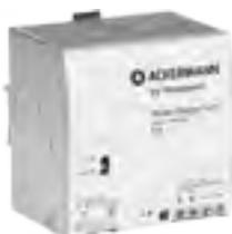
Einphasen-Netzgerät (10 A) für die konstante Gleichstromversorgung der Rufanlage. Kompakte Bauweise durch moderne primärgetaktete Schaltungstechnik (gem. EN 6100-3-2), geeignet zur Hutschienenmontage in der Unterverteilung. Mit Hilfe des Montagekits (Sicherheitsabdeckung) 89954MB ist auch die Wandmontage außerhalb der Unterverteilung möglich. Der Ausgang des Netzgerätes ist leerlauf-, überlast- und kurzschlussfest.
