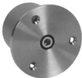
Sensortaster als Ruftaster mit LED-Findellicht und Beruhigungslampe - rot - und 4-mm-Messingfrontplatte, glanzverchromt, ø 70 mm und 3 Innensechskantschrauben als Frontplattenbefestigung.
