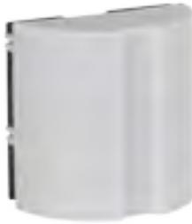
Richtungsleuchte mit 2 Lampenkammern (neutrale Ausführung, Beschriftungssatz beiliegend) zur Richtungsanzeige von Systemmeldungen aus unterschiedlichen Funktionsbereichen der übergeordneten Steuereinheit (hier: Gruppenzentrale). Prioritätsgesteuerte Anzeige mit unterschiedlichen Blinktakten für die Prioritäten Alarmruf – Notruf – Ruf.
