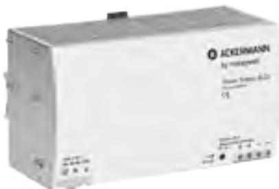
Einphasen-Netzgerät (20 A) für die konstante Gleichstromversorgung der Rufanlage. Kompakte Bauweise durch moderne primärgetaktete Schaltungstechnik (gem. EN6100-3-2), geeignet zur Hutschienenmontage in der Unterverteilung. Mit Hilfe des Montagekits (Sicherheitsabdeckung) 89954MC ist auch die Wandmontage außerhalb der Unterverteilung möglich. Der Ausgang des Netzgerätes ist leerlauf-, überlast- und kurzschlussfest.
