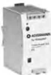
Einphasen-Netzgerät (5 A) für die konstante Gleichstromversorgung der Rufanlage. Kompakte Bauweise durch moderne primärgetaktete Schaltungstechnik, geeignet zur Hutschienenmontage in der Unterverteilung. Mit Hilfe des Montagekits (Sicherheitsabdeckung) 89954MA ist auch die Wandmontage außerhalb der Unterverteilung möglich. Der Ausgang des Netzgerätes ist leerlauf-, überlast- und kurzschlussfest.
