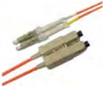
Hochwertiges Fiber Optic Patchkabel Multimode 50/125 µm, Duplex, LC auf SC, Länge 2 m. Zur Verbindung des GBIC Moduls (SC) mit einem Patch-Panel (LC).
