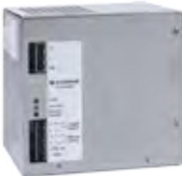
Gerätekombination aus Einphasen-Netzgerät (0,8 A) für die konstante Gleichstromversorgung sowie unterbrechungsfreier Stromversorgung (Online DC-USV) von selektiven Einheiten des Patienten-Rufsystems. Kompakte Bauweise durch moderne primärgetaktete Schaltungstechnik mit integriertem Batteriemodul, vorbereitet auf eine Hutschienenmontage in der Unterverteilung. Der Ausgang des Netzgerätes ist leerlauf-, überlast- und kurzschlussfest.
