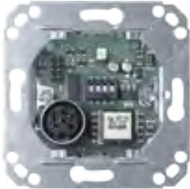
Interface zur Ansteuerung eines TV Gerätes im Patientenzimmer. Die Übertragung der Steuerbefehle erfolgt von einem zugeordneten Bettenmodul oder einer Wandelektronik. Die Steuerbefehle werden in die Kontrollkommandos des TV-Gerätes umgesetzt. Die Tonsignale des TV-Gerätes werden galvanisch getrennt und an den Audio-Pegel des Bettenmoduls/der Wandelektronik angepasst.
