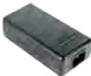
Einphasen-Netzgerät (2 A) für die konstante Gleichstromversorgung Systemo Control, ausgestattet mit einem P1J-Stecker. Geschützt gegen Kurzschluss, Überlast und Überspannung, mit Zulassung gemäß EN60601-1 für den Versorgungsbereich B (z.B. Intensivstation).
