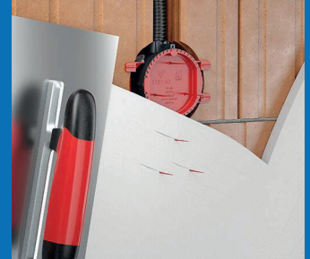
Die feinen Markierungsborsten des Signaldeckels zeigen nach dem Verputzen die genaue Position der Gerätedose an.
