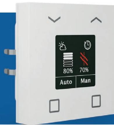
Der MDT **Jalousietaster Smart 55 mit Farbdisplay** löst nach dem Betätigen der Schaltflächen abhängig von der Parametrierung KNX-Telegramme aus. Die Ausführung mit 4 mechanischen Tasterflächen und integrierter Zeitschaltuhr zur Steuerung der Jalousien ist passend für 55mm Schalterprogramme. Der Jalousietaster Smart 55 verfügt über ein aktives Farbdisplay zur Funktions- und Statusanzeige, somit wird der Status der Jalousie optimal angezeigt.
