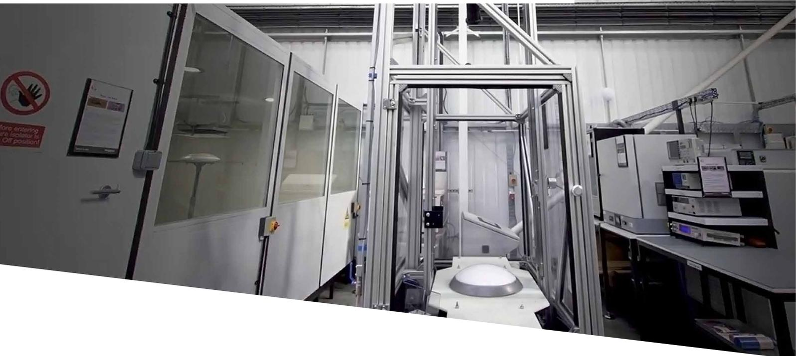
**Die offizielle IK-Skala reicht nicht aus, um die Widerstandsfähigkeit eines Produktes unter den harten Bedingungen einer JVA zu bewerten. Daher durchlaufen unsere Produkte den Härtetest.**
